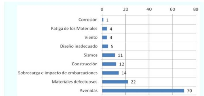
Fig. 4: número de fallas, de acuerdo a su origen, ocurridas en 143 recuperado de “Bridge failures” que realizó D. W. Smith
