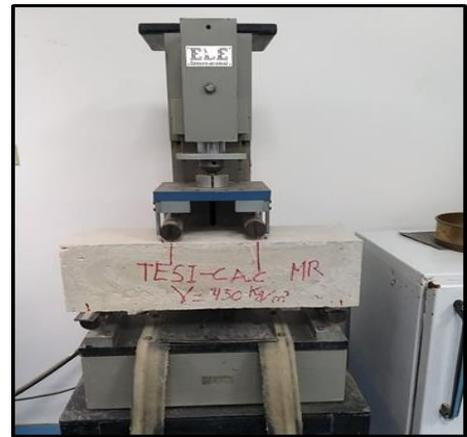
Fig. 6. Aplicación de carga para vigas.
