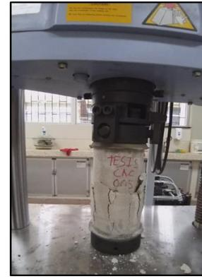
Fig. 4. Aplicación de carga axial.
