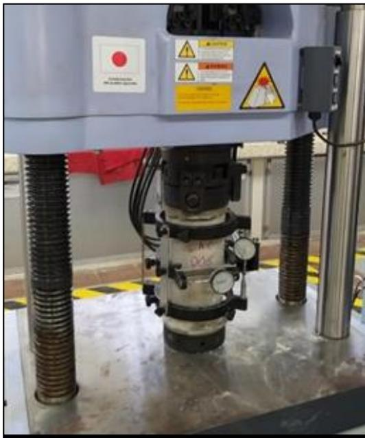
Fig. 8. Ensayo de Modulo elástico estático
