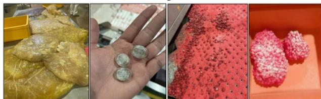
Fig. 3 Rotura de Masa, Caramelos sin Relleno, combinados y pegados
