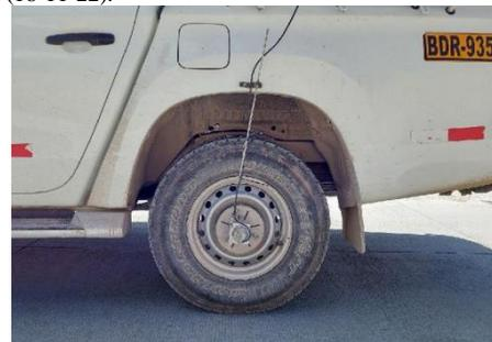
Fig. 3. Odómetro de alta resolución para medición de la distancia recorrido (19-11-22).
