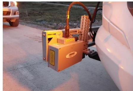
Fig. 2. Sistema laser – Acelerómetro instalado para la recolección del perfil longitudinal (18-11-22).
