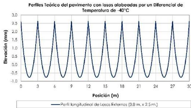
Fig. 9. Perfil teórico de una serie de losas alabeadas sometido a un diferencial de temperatura de -40°C.
