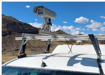
Fig. 4. Cámara frontal y antena del módulo DGPS para captura de coordenadas de posicionamiento global (19-11-22).
