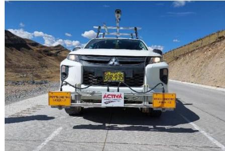
Fig. 1. Vehículo de auscultación empleado para la medición de perfiles longitudinales del pavimento evaluado (19-11-22).
