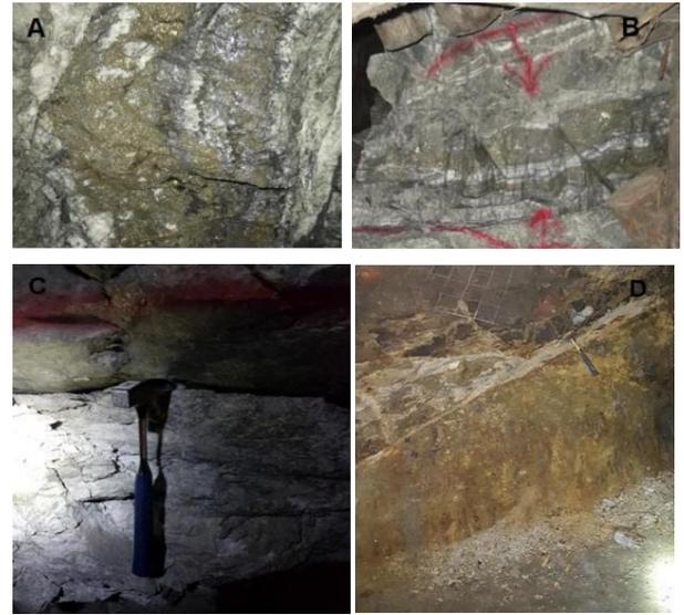
**Figura 9:** Diversas estructuras en las vetas del Yacimiento El Gigante. Estas incluyen bandas de pirita – cuarzo - marmatita (A, B y E), lentes (D) y cizallamiento (C)
