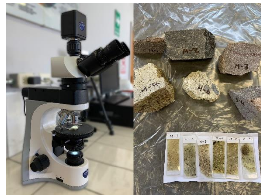
Fig. 6. Izquierda: Microscopio Petrográfico, Derecha: Secciones delgadas y pulidas.
