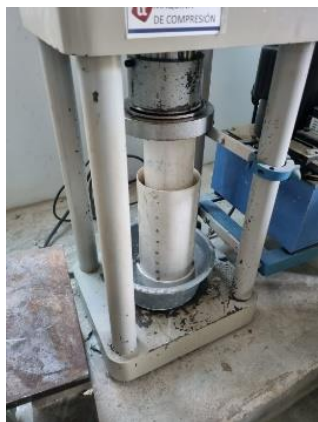
Fig. 3. Compactación de mezclas tipo 1 y 2.
