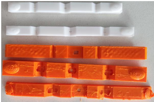
Figura 4. Prueba piloto de impresión 3D.
