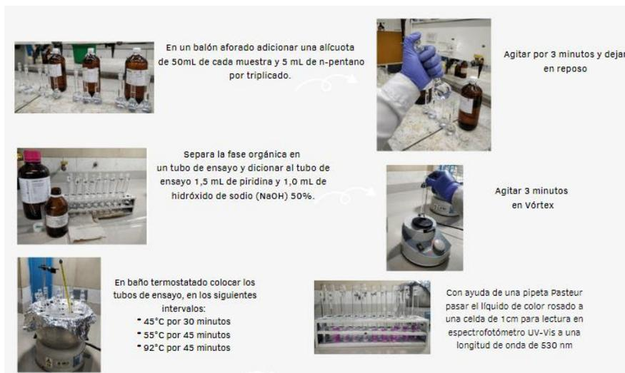
**Figura 4.** Técnica para la determinación de THMs.
