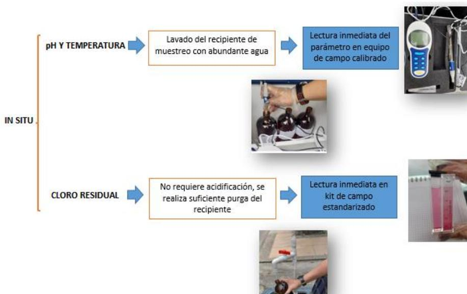
**Figura 2.** Muestreo para la determinación de parámetros In Situ
