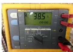
Fig. 8 Equipo para medir puesta a Tierra 1625-2GEO
