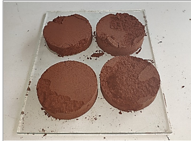
Figure 6. Discos con presiones inferiores a 39.2266N
