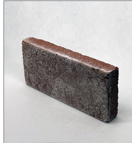
Figure 12. Prototipo LTT, con eflorescencias
