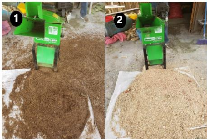
Ilustración 2 Proceso de triturado: (1) vena de tabaco y (2) olo de maíz Fuente: Elaboración propia
