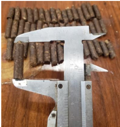
Ilustración 6 Medición de la longitud de los pellets de vena de tabaco
