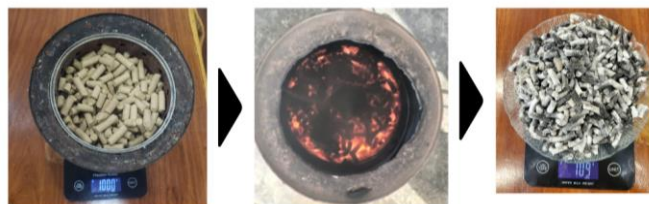
Ilustración 11 Proceso para determinar el contenido de cenizas de los pellets de casulla de arroz
