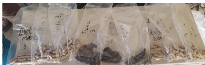
Ilustración 10 Muestras de pellets de casulla de arroz, vena de tabaco, y olote de maíz previo a determinar su poder calorífico
