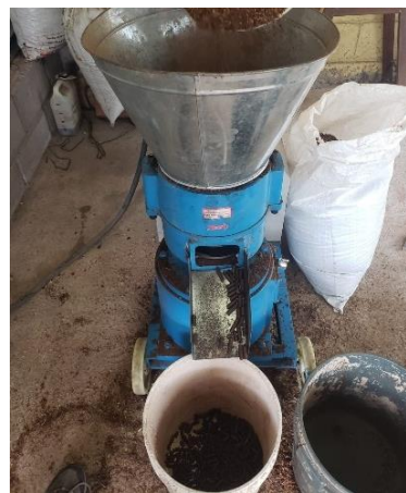
Ilustración 4 Proceso de pelletizado de la vena de tabaco Fuente: Elaboración propia
