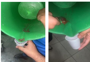
Ilustración 7. Extracción de residuo de bloque y teja
