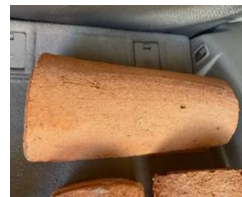
Ilustración 11. Teja con 20% de agregado de casulla de café
