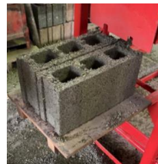
Ilustración 10. Bloque con 20% de agregado de casulla de café
