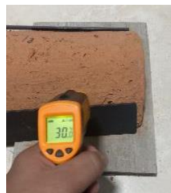
Ilustración 5. Medición de temperatura de platinas en tejas
