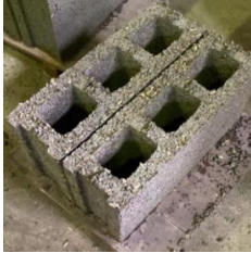
Ilustración 14. Bloque con 80% de agregado de casulla de café
