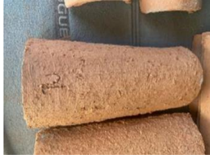
Ilustración 13. Teja con 50% de agregado de casulla de café
