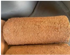
Ilustración 15. Teja con 80% de agregado de casulla de café
