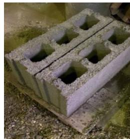
Ilustración 12. Bloques con 50% de agregado de casulla de café
