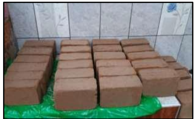
Figura 4: Unidades de albañilería elaboradas con la máquina CINVA RAM Fuente: [32]
