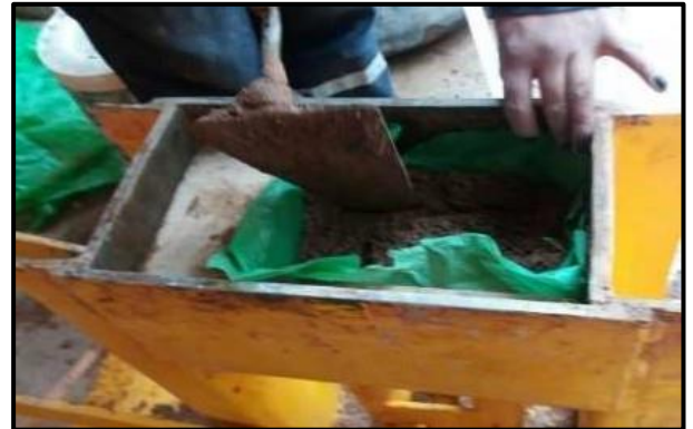
Figura 3: Mezcla depositada en la máquina CINVA RAM Fuente: [32]
