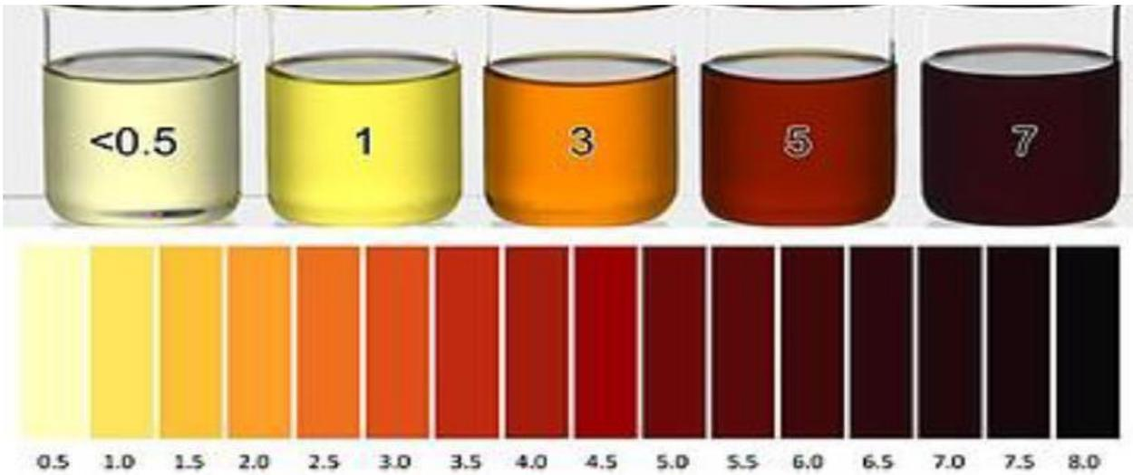
Fig. 2 Escala de colores según método estándar ASTM D1500
