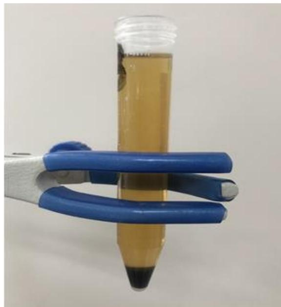
Fig. 4 Intensidad del color resultante en la base lubricante tratada con ácido sulfúrico y centrifugación
