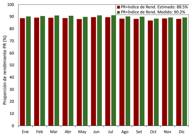
Fig. 8. Proporción de rendimientos PR con TNOCT y con temperatura de celda medida del SFCR de 3.0kW. con optimizadores.
