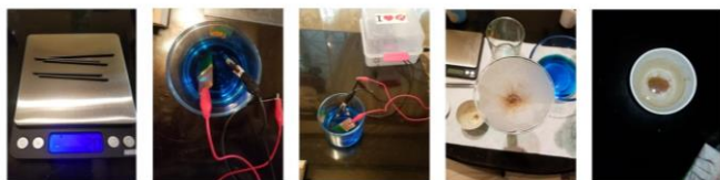
Fig. 5 Proceso electroquímico de 9V muestra madre. Fuente: Propia (2020).
