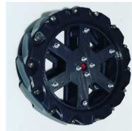
Fig. 8 Rueda Omnidireccional impresa en 3D
