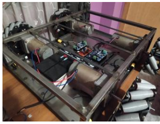
Fig. 10 Estructura Metálica completa con componentes electrónicos
