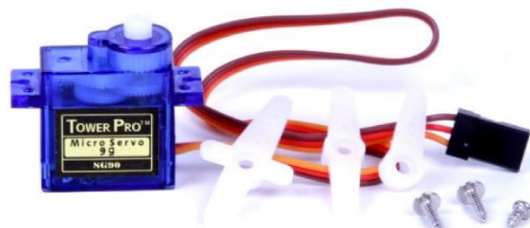
Figura 8: Micro servomotor que foi utilizado no projeto [25].
