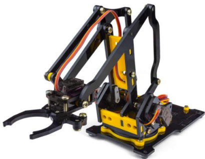
Figura 7: Manipulador com 3 graus de liberdade a ser utilizado no projeto [24].
