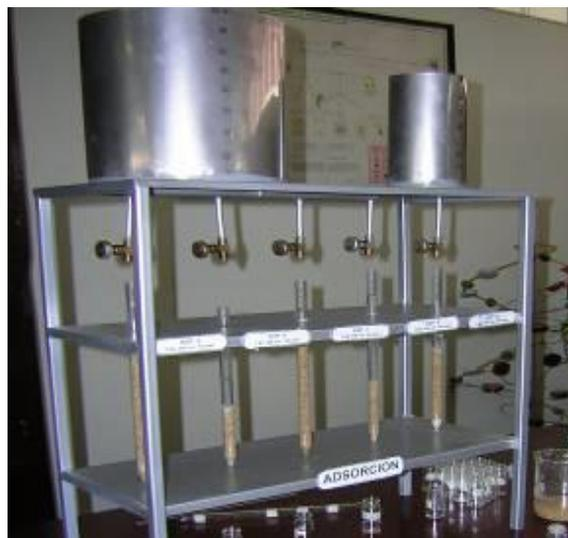
Fig. 2 Equipo de adsorción de lecho fijo.
