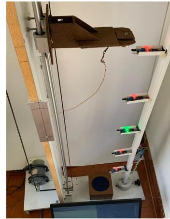
Fig 4. Montaje experimental para la planta de caída libre
