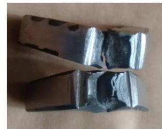
Fig.19: Probeta fracturada A36-A615 dúctil y tenaz
