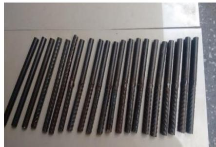
Fig.13 Probetas soldadas de A615 y A36 [21]
