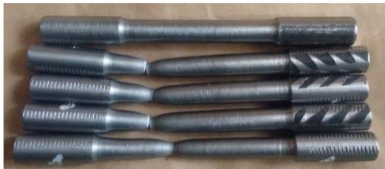
Fig. 17: Probetas preparadas y procesadas, con rotura fuera de la zona de soldadura y de la zona ZAC. [21]
