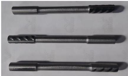
Fig. 16: Probetas de acuerdo a Norma ASTM E8.[15][16]
