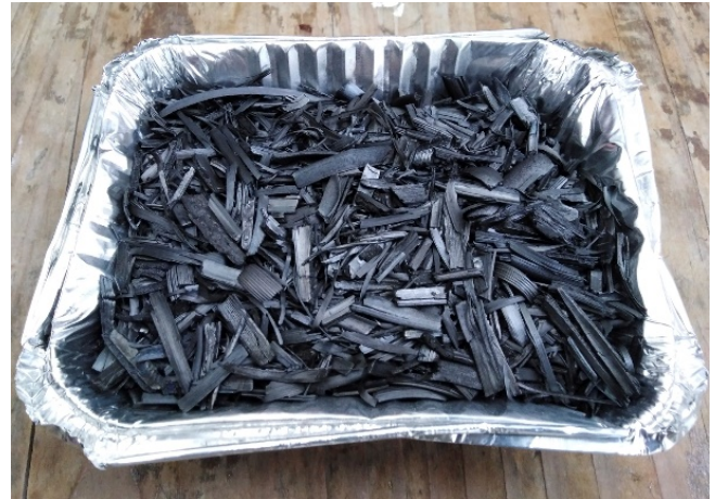
Fig. 7 Hojas de caña luego del proceso de lavado, tostado y carbonizado
