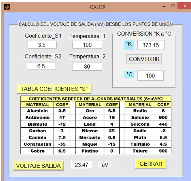
Fig. 6. Voltaje de salida para Aluminio-Oro
