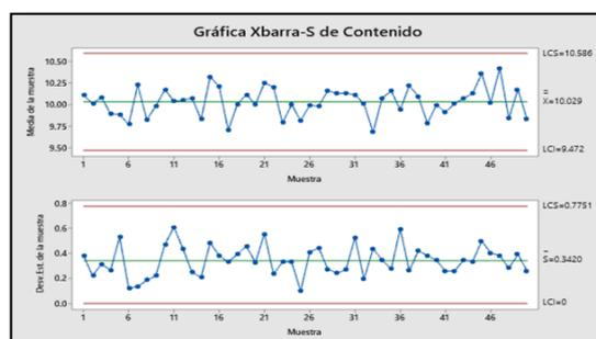
**Fig. 8:** Grafico de control Xbarra-S de la variable contenido(masa)
