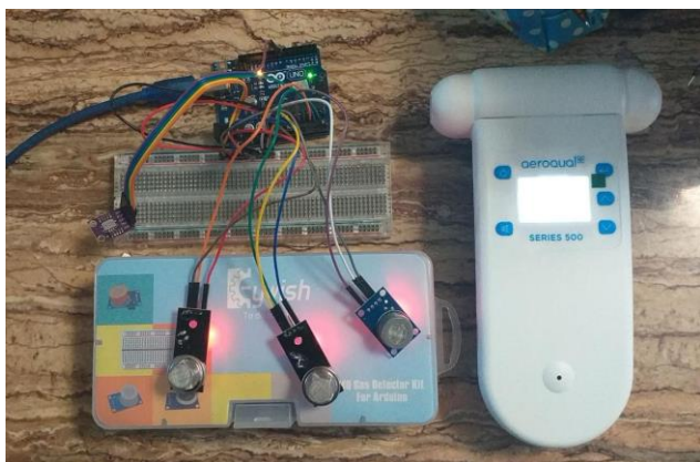
Fig. 5. Calibración de los sensores de monóxido de carbono, dióxido de azufre y ozono.
