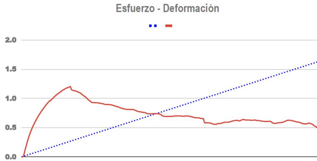
Fig.6 Gráfica Esfuerzo-Deformación, material compuesto de rPET y virutas metálicas.
