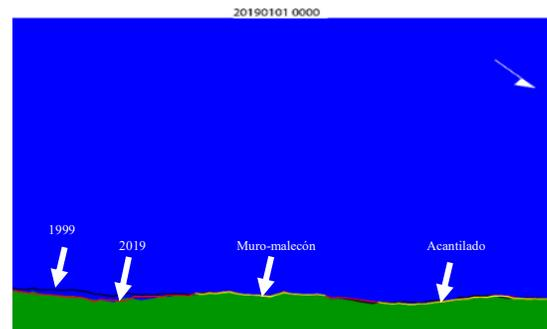
Fig.4 Fin de la modelación de la variación línea de costa de la playa de La Entrada 1999-2019 con Modelo Numérico CEDAS. Fuente: Los autores, 2019.
