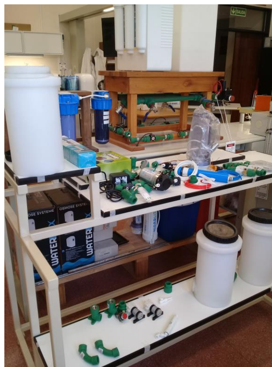
Fig. 3 Planta piloto de purificación de agua (PPPA) como Objeto de Aprendizaje, en la etapa de construcción y ensamble. Fuente: Laboratorio LMFA FiUNLZ.
