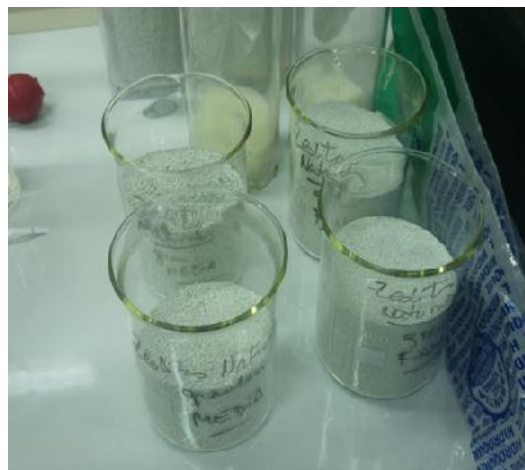
Fig. 1 Zeolita Natural del tipo CLI sódica de grano medio y grano fino utilizada en la investigación.
