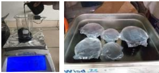
Fig. 3: Proceso de dispersión de NTC mediante la sonicación
