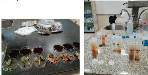
Fig. 2 Muestras de suelo contaminado (a), macetas con las plantas de geranio (b) y preparación de las muestras para el análisis de los metales mediante ICP-OES (c).
