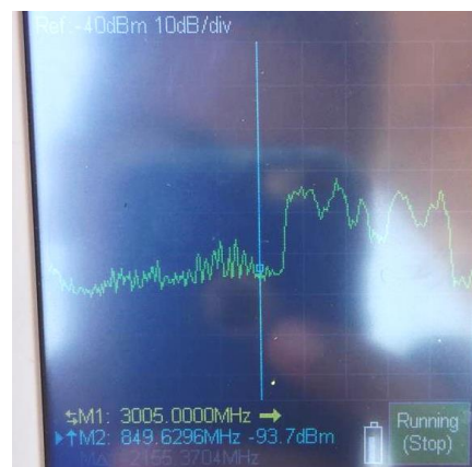
Fig. 10 Patrón espectral de la banda de 850 MHz posterior a la implementación del sistema repetidor.
