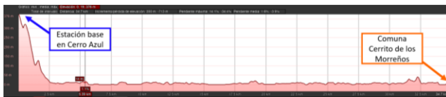
Fig. 6 Perfil topográfico del enlace
