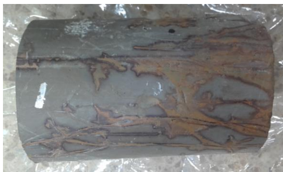
Figura 3: Shelby extraído en el occidente de la Ciudad de Bogotá a una profundidad de 10 (m) a 11,50 (m).
