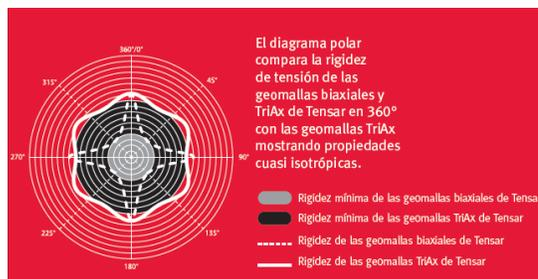
Fig. 2 Distribución radial de las geomallas Triaxiales
