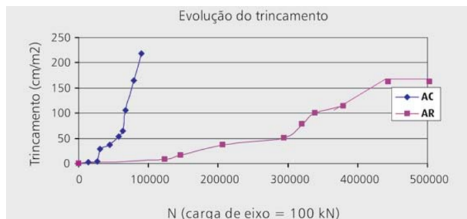
Figura 1 - Evolução do trincamento para o AC e o AR. Fonte: Empresa responsável pelos testes.
