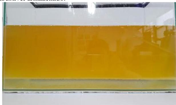
Fig. 3 – Protótipo escala laboratório de tanque de armazenamento de combustível com água livre decantada.
