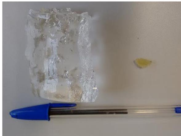
Fig. 2 Comparativo de amostra de hydrogel de PAAm-AS intumescido e desidratado.
