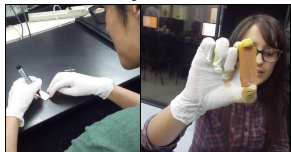
Fig. 2. Dibujar y quemar la placa
