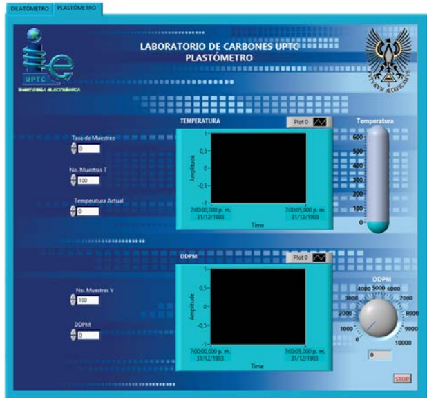
Fig. 17. Panel Frontal Instrumento Virtual para Monitoreo del Plastómetro.
