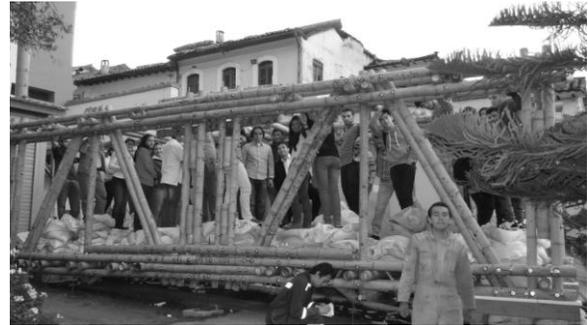
Figura 8: Prueba de carga a puente peatonal en guadua angustifolia, pensado principalmente para zonas rurales. Universidad de La Salle, Bogotá D.C., Colombia (2013).
