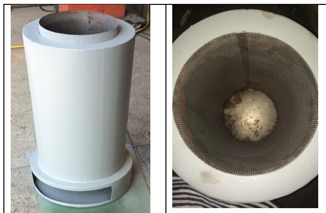
Fig. 5. Construcción del prototipo experimental
