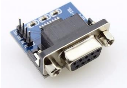
Fig. 4 Módulo de conversión de RS-232 a TTL para la comunicación entre el microcontrolador y el datalogger
