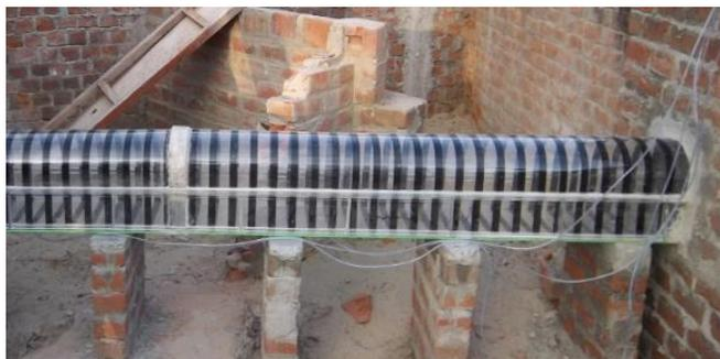
Fig. 8. Ensayo del túnel de 3.4 m. con distanciamiento entre cintas de 4 cm en toda su longitud.
