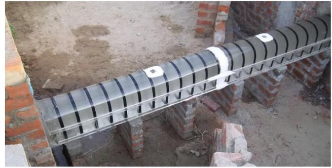
Fig. 7. Ensayo del túnel de 3.4 m. con distanciamiento entre cintas de 10,4 cm en toda su longitud.
