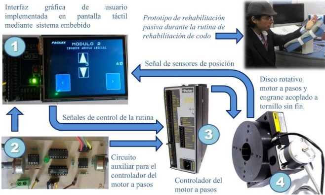
Fig. 1. Esquema de las 4 partes principales que integran el prototipo de rehabilitación pasiva de brazo. 1) Interfaz gráfica de usuario implementada en pantalla táctil mediante sistema embebido, 2) Circuito de control de la velocidad del motor a pasos, 3) Controlador de potencia del motor a pasos y 4) Disco rotativo conformado por engrane y tornillo sin fin acoplado al motor a pasos.
