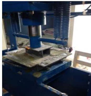
Fig. 3 Prensa hidráulica aplicando presión en la baldosa prototipo
