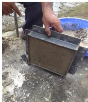
Fig. 4 Proceso de desmolde de baldosa
