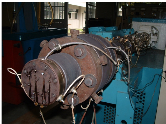
Fig. 4 Vista de Dado rediseñado en extrusora de tornillo simple
