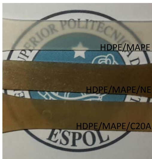
Fig. 11. Aspecto visual de los nanocompuestos de HDPE/MAPE con las organoarcillas C20A y NE.
