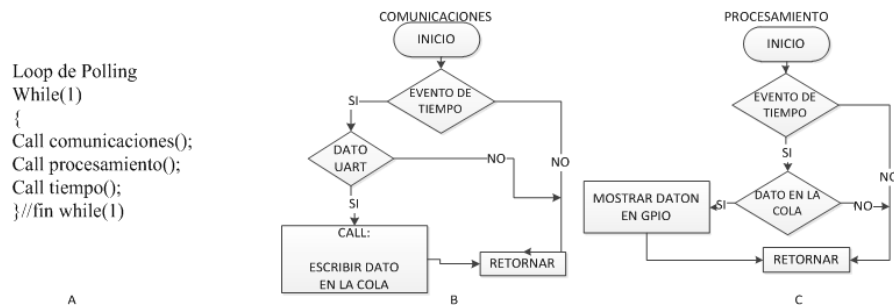
Figura 6. Polling Loop para el diagrama de estructura compuesta
