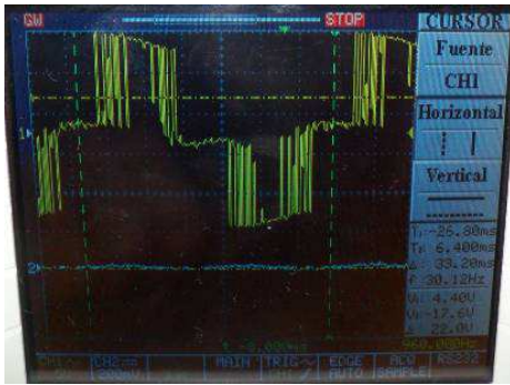
Figura 20. Voltaje de fase con frecuencia de 30 Hz.
