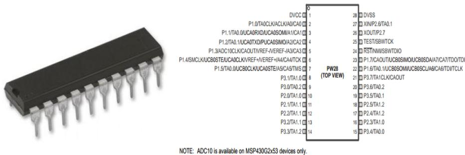
Fig. 5 Microcontrolador MSP430G2553 y su configuración de pines.
