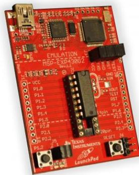
Fig. 6 Tarjeta de Desarrollo y Programación LaunchPad de Texas Instruments.
