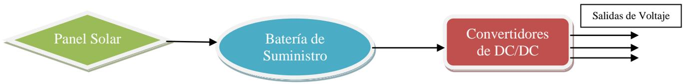
Fig. 2 Diagrama de Bloques que componen el sistema de alimentación
