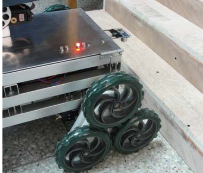
Figura 7: Detección de grada de subida (led rojo).
